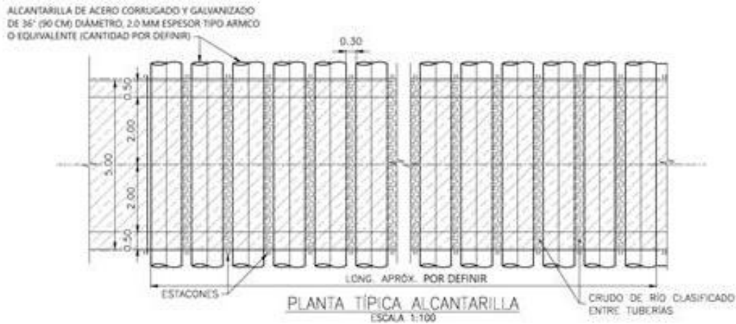
Figura 4-27 Sección en planta alcantarilla tipo
