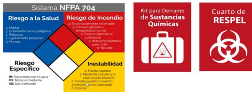
Figura 7-4 Rotulación sistema NFPA 704
