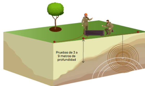
Ilustración 18. Pruebas sísmicas mediante el uso de explosivos.
