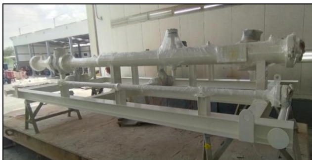
Figura 2. Trampa de Despacho 6"x8" rating 600#
